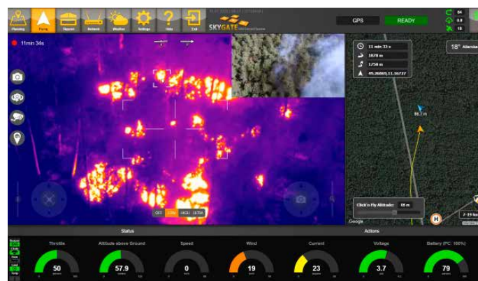
Abb. 3: Momentaufnahme des Drohnen-Statusbildschirms mit Infrarotbild, normalem Bild (kleine Einblendung im Infrarotbild oben rechts) und Flugbahn der Drohne (rechtes Bild) sowie einigen Statusanzeigen.
