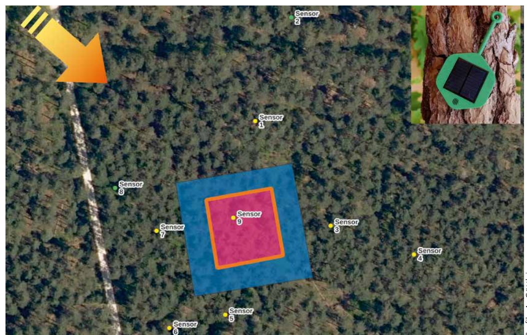
Abb. 1: Versuchsanlage mit Positionierung der Sensoren; rot: Brandfläche 30 m x 30 m, orange: Frässtreifen; blau: bewässerter Sicherheitsstreifen 10 m; Luftbild DOP20 (©Bayerische Vermessungsverwaltung 2018); oben links eingetragen mittlere Windrichtung während der Brandzeit; oben rechts Bild der verwendeten Brandsensoren (aus [2])
