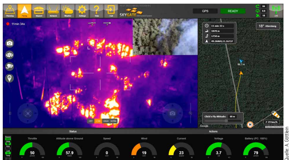
Abb. 3: Momentaufnahme des Drohnen-Statusbildschirms mit Infrarotbild, normalem Bild (kleine Einblendung im Infrarotbild oben rechts) und Flugbahn der Drohne (rechtes Bild) sowie einigen Statusanzeigen.
